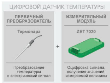
Рисунок 3 – Принцип измерения цифровых датчиков
