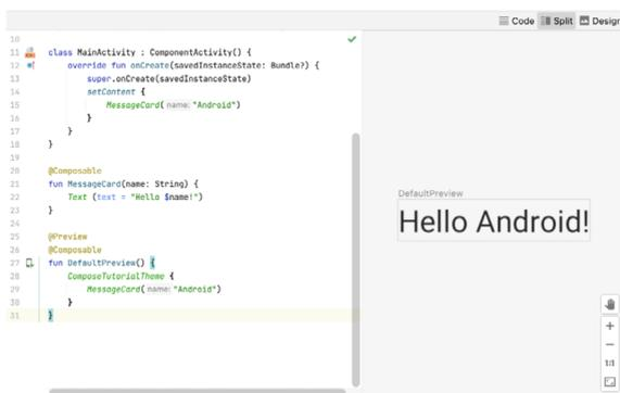
Рисунок 1 – Предварительный просмотр элемента
