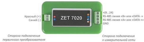
Рисунок 2 – Обозначение контактов цифрового датчика ZET7020
